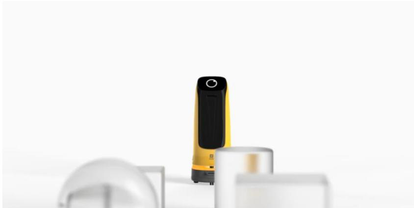
Impulsado por el algoritmo Slam de PUDU, KettyBot es compatible con la solución dual slam por láser y slam visual simultáneamente para poder adaptarse a más escenarios.
